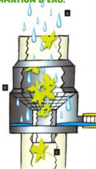
▲ **COLLECTEUR FILTRANT** : les végétaux tombent par la descente pluviale (a), via les gouttières. Ils sont « tamisés » par un filtre (b) et envoyés plus bas par gravitation (c). L'eau filtrée est dérivée vers une cuve fermée (d).
